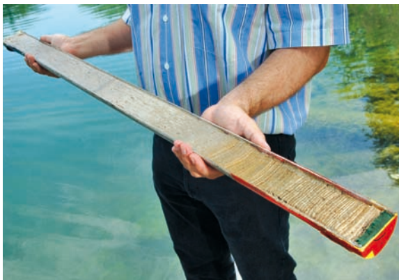
Abb. 3. Sedimentkern aus dem Greifensee bei Dübendorf in der Schweiz mit klar erkennbaren Jahreslagen: Die hellen Schichten sind Ausfällungen von Seekreide im Winter. (Foto: Ruedi Keller)
